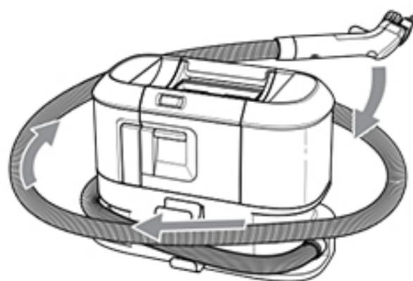
按图示将管道缠绕在管道槽位
